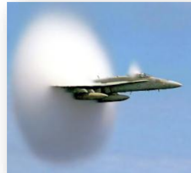
Cono de vapor formado al romper la barrera del sonido. Fuente: Wikipedia
